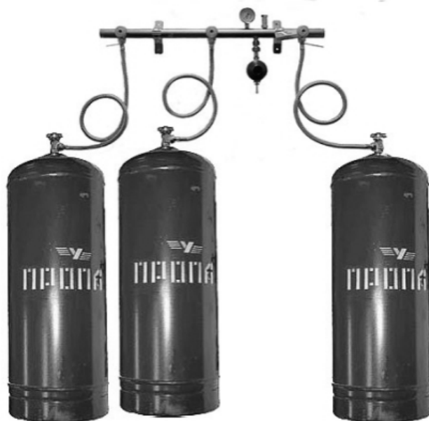
Рис. 20 Баллонная установка из трёх баллонов объёмом 50 л. с коллектором и редуктором (регулятором давления газа).
